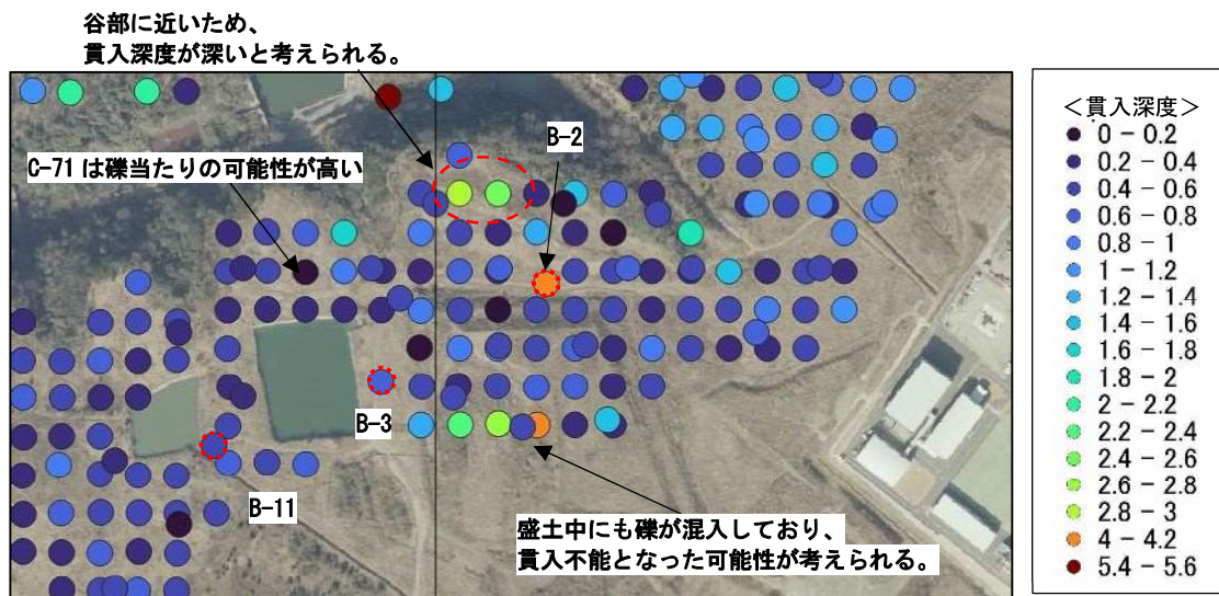
図 4-1-15 C 工区貫入深度分布図
