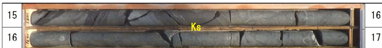
写 4-1-5 Ks 層のコア写真 (B-5 地点 GL-15.0～17.0m)
