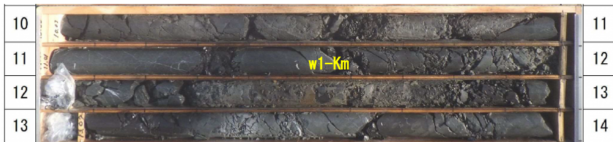
写 4-1-3 w1-Km 層のコア写真 (B-5 地点 GL-10.0～14.0m)
