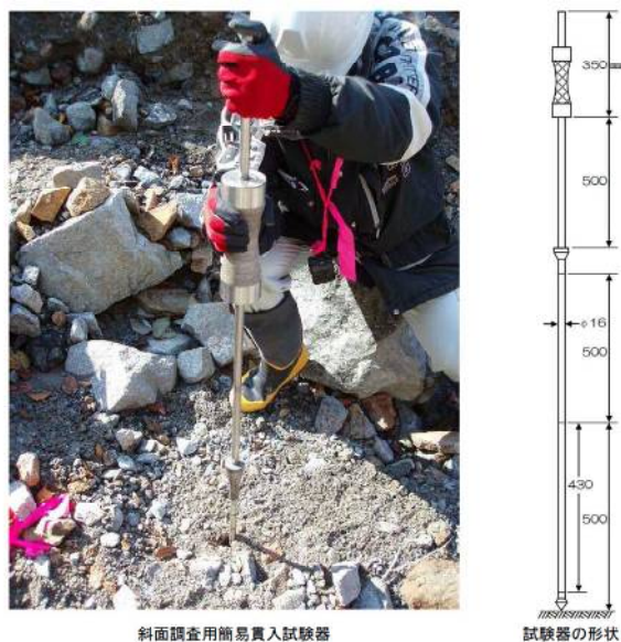
図 2-4-1 簡易動的コーン貫入試験の概要
