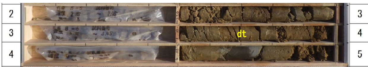
写 4-1-2 dt 層のコア写真 (B-5 地点 GL-0.0～5.0m)
