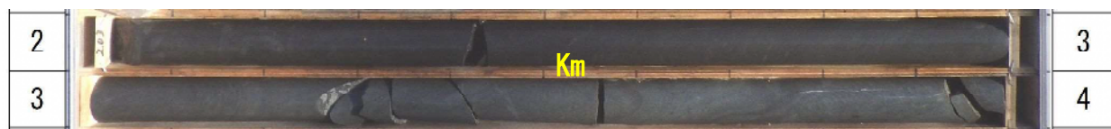
写 4-1-4 Km 層のコア写真 (B-5 地点 GL-2.0～4.0m)
